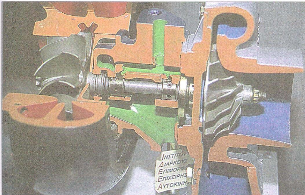
Εικ. 2.5.1 Τομή στροβιλοσυμπιεστή
